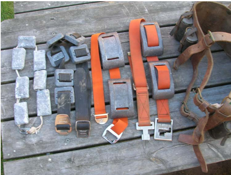
Några exempel på viktbälten med olika spännen. De två längst till höger används vid tung yrkesdykning.
